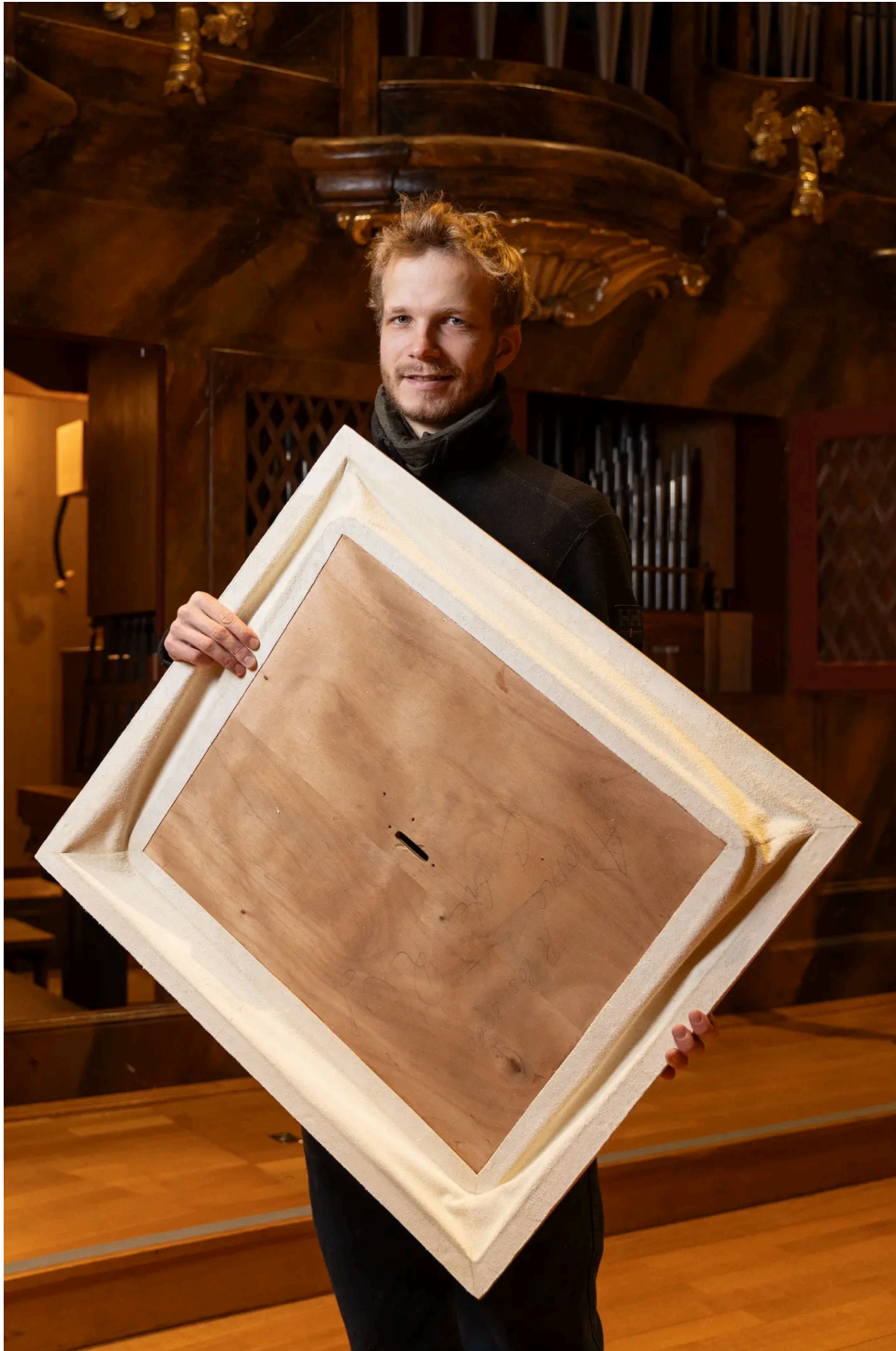
Orgelbauer Friedrich Caspar mit einem der Schwimmbälge, die er in der Werkstatt in Männedorf repariert hat.
